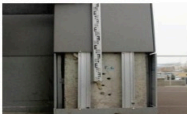
Сурет 3. Ғимарат бағаналарындағы мониторингтік нивелирлік нүктелер
